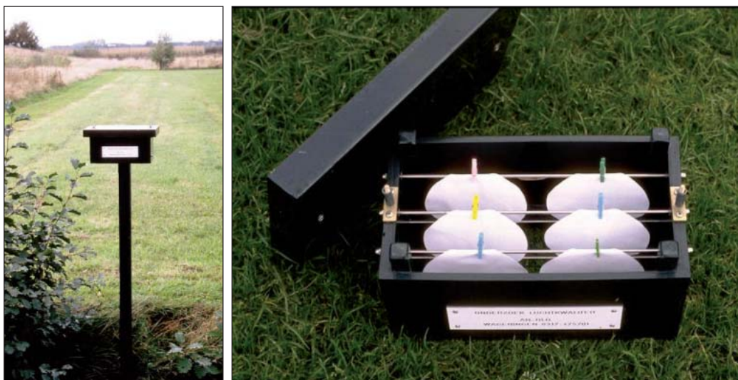
Figuur II-3. Links een 'fluoridenkastje' in het veld en rechts een bovenaanzicht van het kastje met de geïmpregneerde filtreerpapiertjes.
